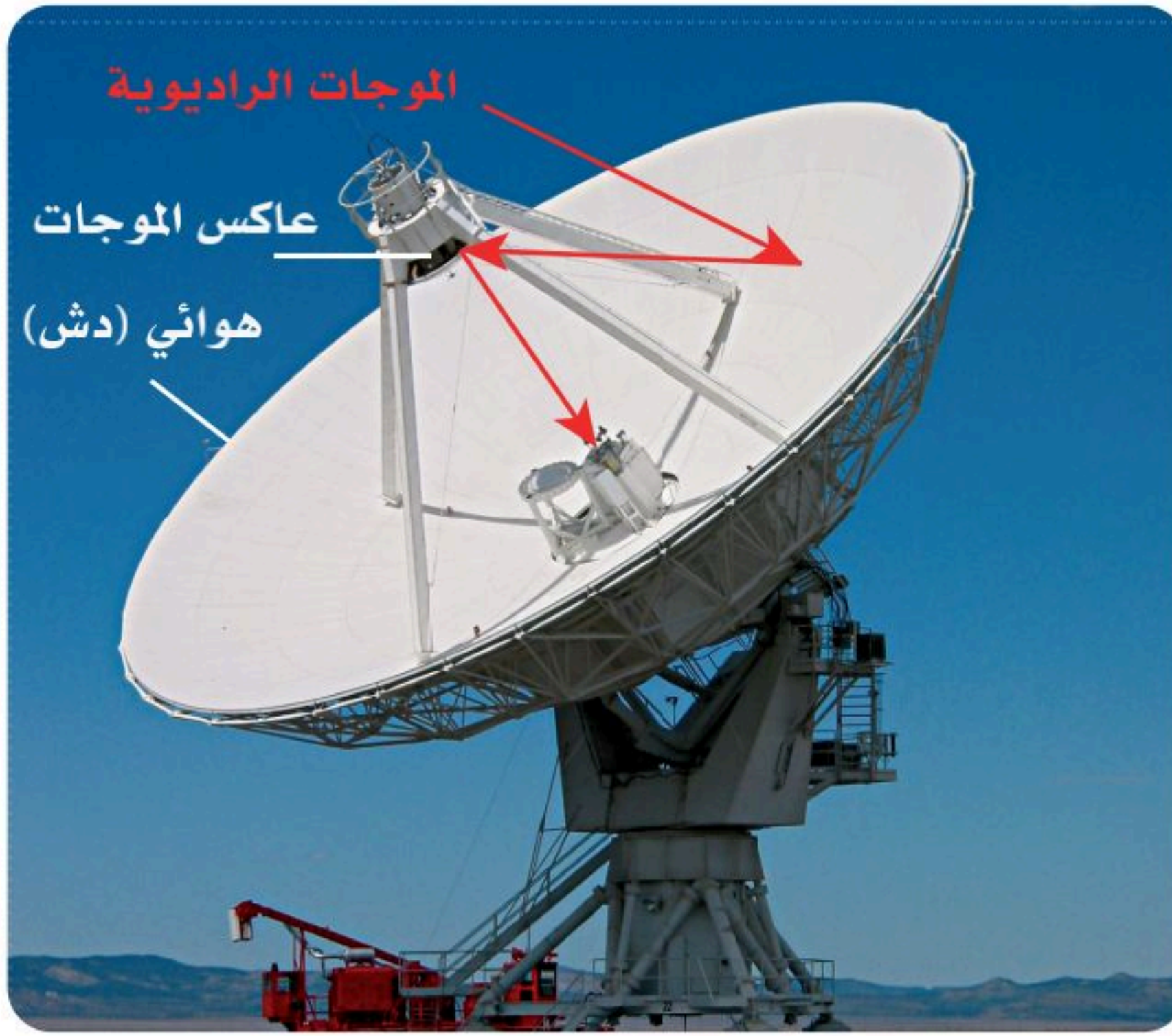
الشكل 14-3 تركيب المنظار الراديوي.
