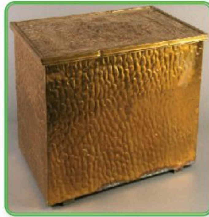
الشكل (١١٣): الطرق بالدق بالأزاميل.
