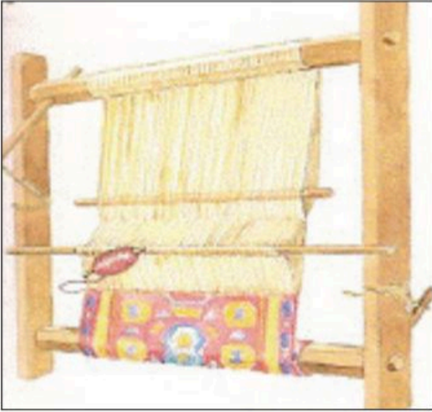
الشكل ( ١٧٦ ) : نول الكلیم ويلاحظ فيه تباعد خيوط السدى بما يتناسب مع التصميم المرسم .
