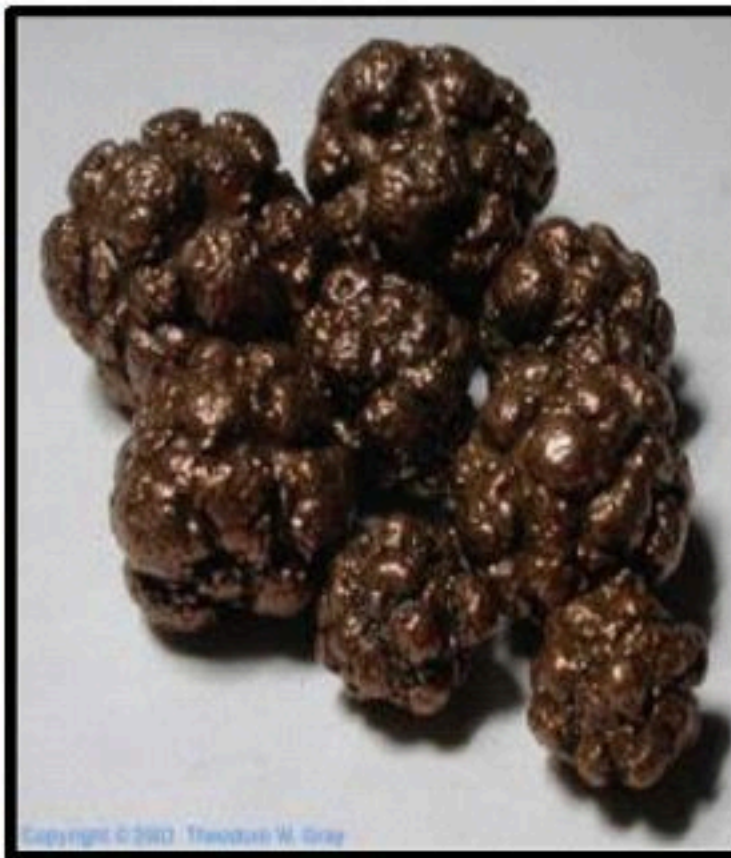
الشكل (١٠٦): قطع من النحاس الخام الطبيعي.
