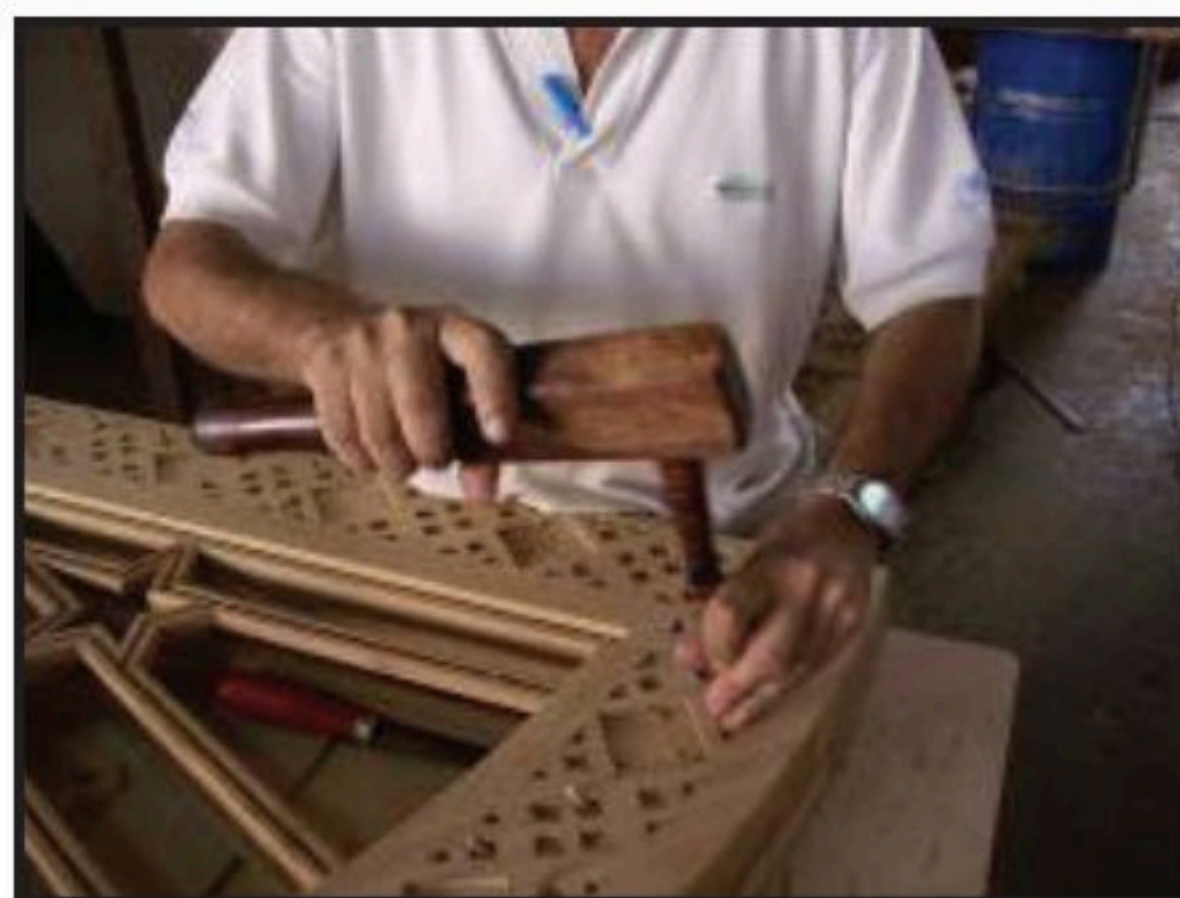
(١): استخدام المدق الخشبي، وهي الأداة الصحيحة.
