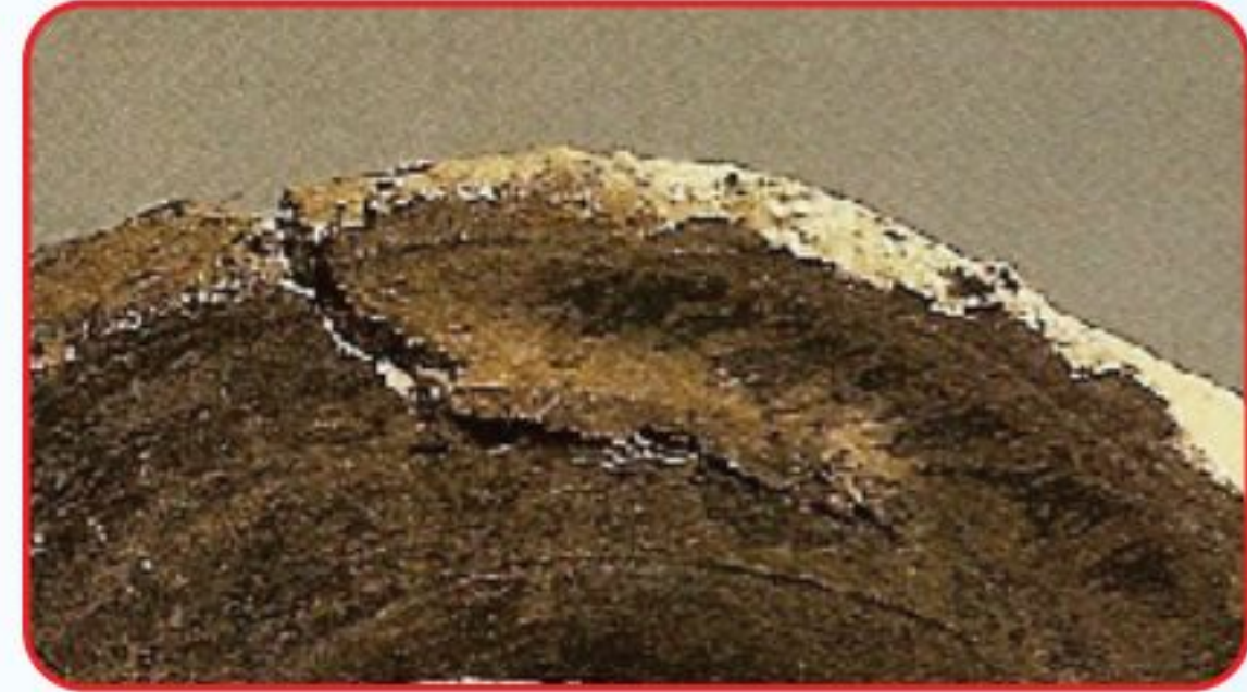
شكل ( ١٠٦ ) : يوضح نتائج أخطاء التجفيف ( تشقق ).
