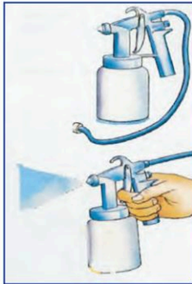
الشكل (٣٢) : بخاخة موصلة بمضخة.
