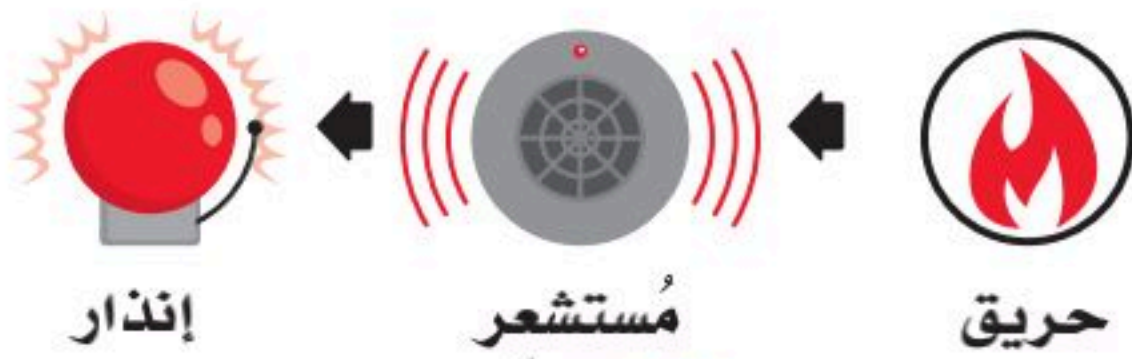
شكل 5.2: نظام إنذار الحريق
