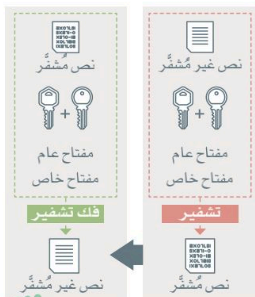
شكل 3.5: عملية التشفير باستخدام المفتاح غير المتماثل
