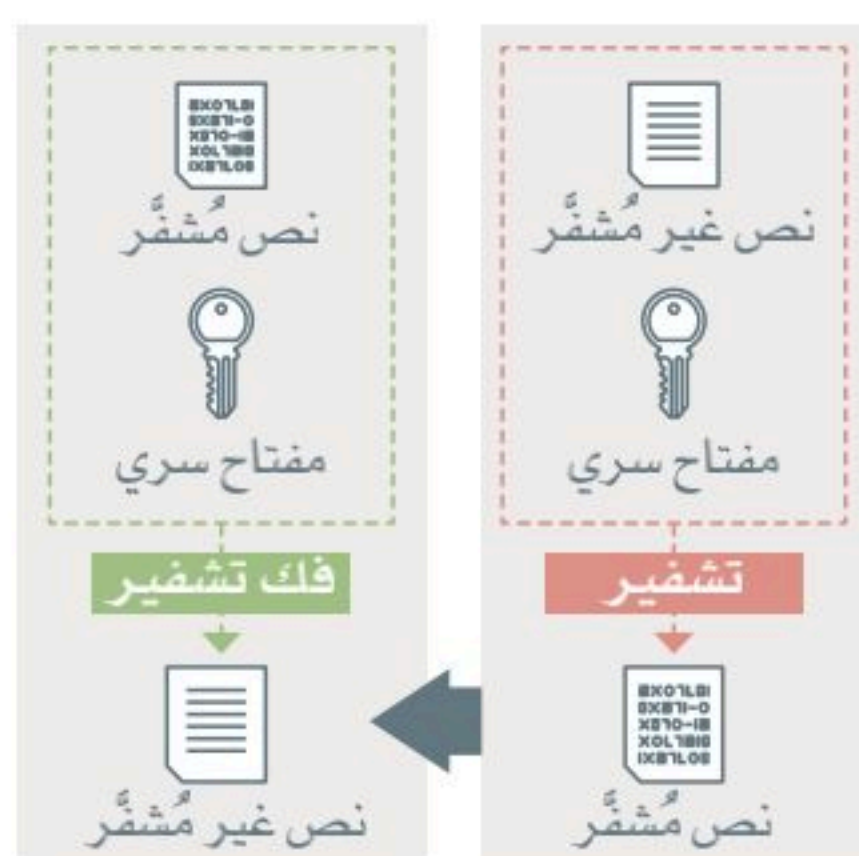
شكل 3.4: عملية التشفير باستخدام المفتاح المتماثل
