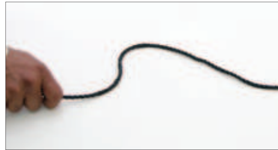
■ الشكل 2-7 تم التقاط هاتين الصورتين بفارق زمني 0.20 s، وخلال هذه الفترة تحركت القمة مسافة 0.80 m، فتكون السرعة المتجهة للموجة 4.0 m/s.
