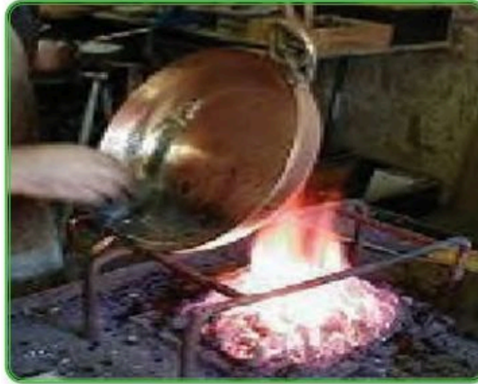
الشكل (٢٧): التخمير «تسخين المعدن لإكسابه اللدونة».
