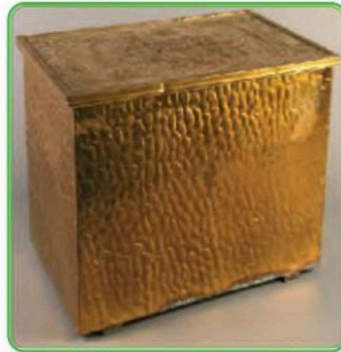
الشكل (٧٣): الطرق بالدق بالأزاميل.
