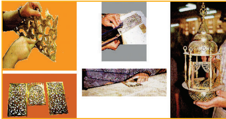
الشكل (٨): طرق استخدام أزاميل ومنشار المعادن
