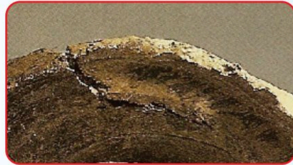
شكل (٥٢): يوضح نتائج أخطاء التجفيف (تشقق).
