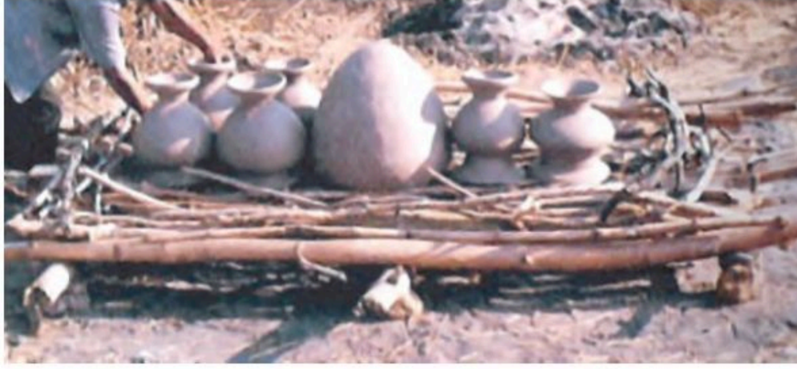
الشكل (١٥): الطريقة التقليدية لتجفيف البطانات.
