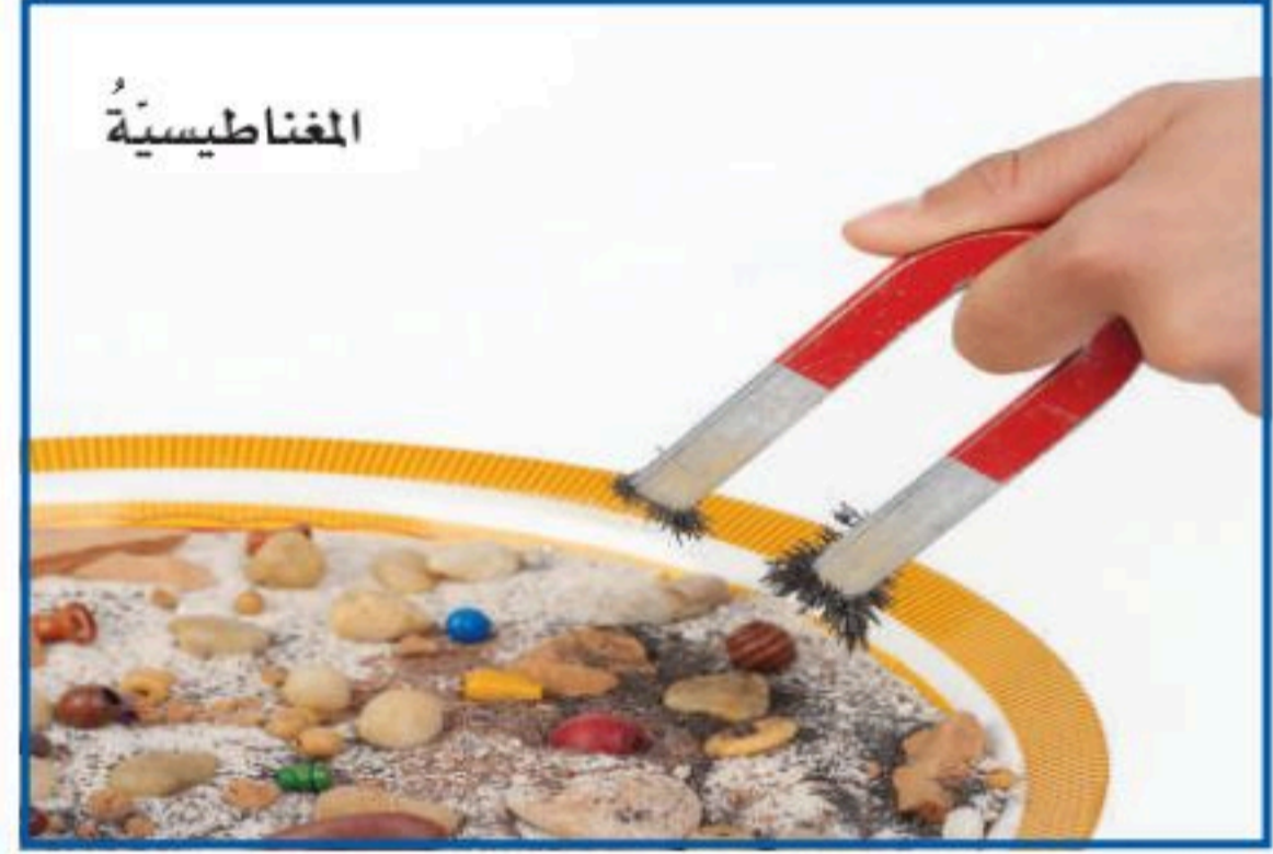
يفصل المغناطيس برادة الحديد عن المواد غير المغناطيسية.
