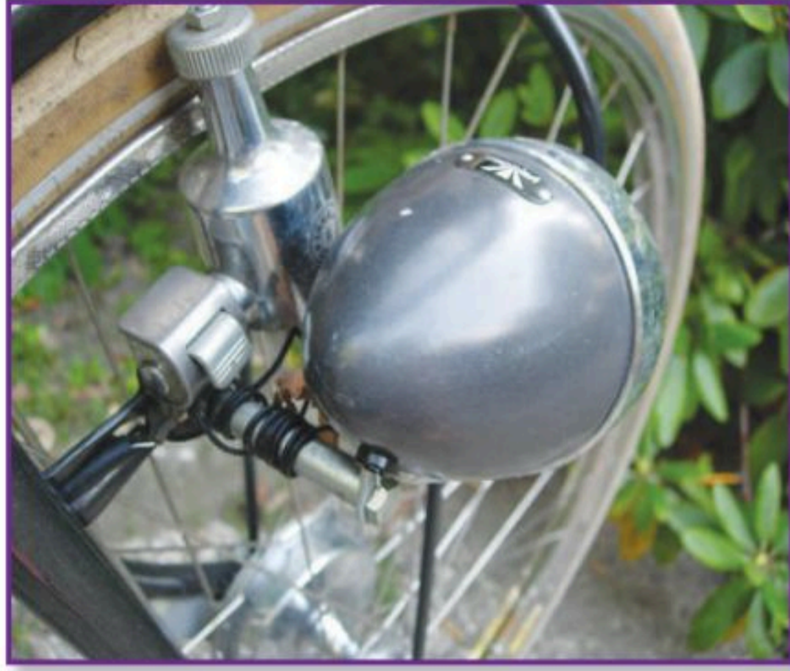
يتصل المولد الكهربائي بعجلة الدراجة
