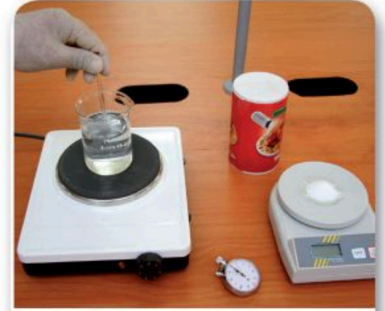
الشكل 1-11 هذه المواد يمكن أن تستعمل لقياس أثر درجة الحرارة في سرعة ذوبان ملح الطعام.
