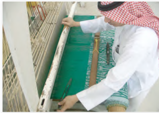
الشكل (٦): نلاحظ كيف يمرر النساخ المكوك .
