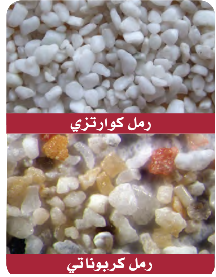
الشكل 24-4 حبيبات الرمل الكربوناتي المنقولة من مسافات قريبة حادة، مدببة الحواف، وليس لها استدارة أو نعومة كحبيبات الرمل الكوارتزي المنقولة من مسافات بعيدة.
