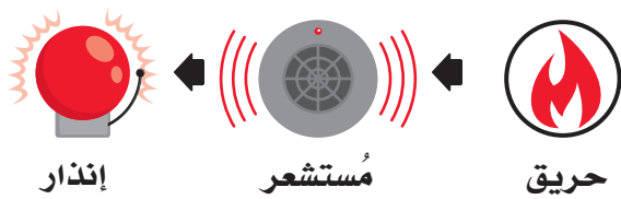
شكل 5.2: نظام إنذار الحريق
