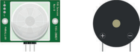
شكل 5.22: مُستشعر الحركة و طنان الكهربائي
