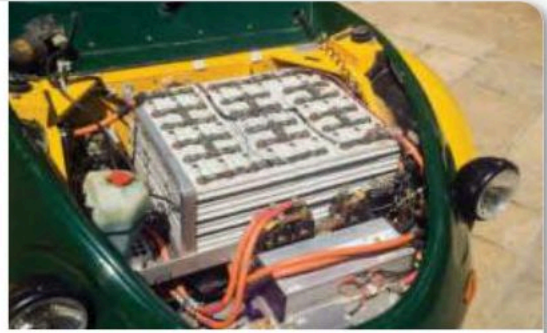
تزود بطاريات الليثيوم سيارة التجربة هذه بطاقة تجعلها تسير بسرعة قصوى مقدارها 113 km/h قبل أن يعاد شحنها . كما أنها تستطيع السير مسافة 320 km
