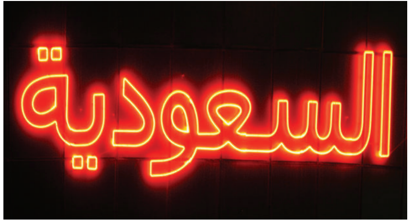
■ الشكل 6-1 تنتج التأثيرات الضوئية الملونة في إشارات النيون عن البلازما المضيئة المتكوّنة في الأنابيب الزجاجية.
