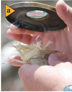
الشكل 10-6 يمكن استخدام عدسة مجمعة لحرق ورقة (a). يتجمع الضوء الداخل بصورة موازية للمحور الرئيس عند بؤرة العدسة، ولذا تتركز الطاقة الشمسية (b).
