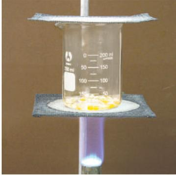
**الخلفية النظرية** عندما يكون ضغط بخار الماء داخل حبات الذرة المجففة (الفشار) كبيراً بشكل كافٍ، تتحول الحبات إلى فشار وتطلق بخار ماء. ويمكن استخدام قانون الغاز المثالي في إيجاد الضغط في هذه الحبات عند انفجارها.
