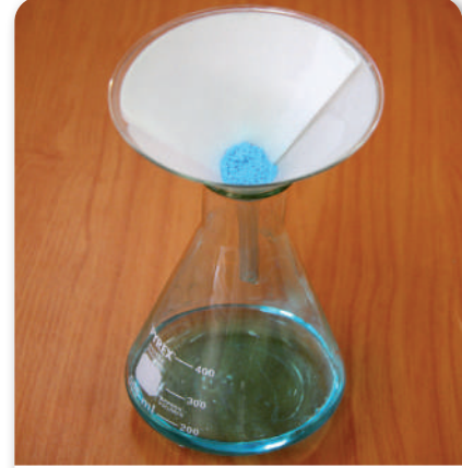
الشكل 2-13 عندما يمر المخلوطة عبر ورقة الترشيح تبقى المادة الصلبة في الورقة، في حين يتجمع السائل المتبقي في الكأس.
