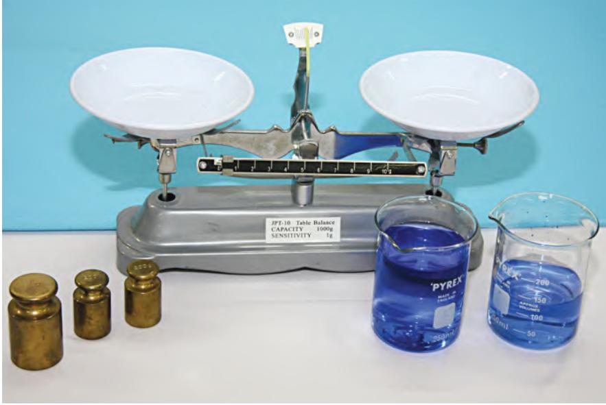
■ الشكل 1-14 يُمكننا الميزان ذو الكفتين المبين في الشكل من قياس كتل الأجسام؛ وذلك بمقارنة قوة جذب الأرض لها بقوة جذبها لكتل معيارية.
