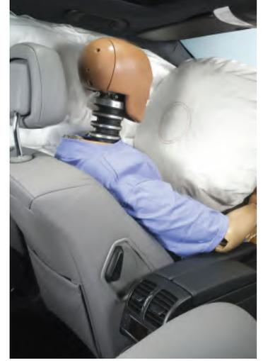
■ الشكل 2-3 تنتفخ الوسادة الهوائية في أثناء التصادم، حيث تسبب القوة الناجمة عن التصادم تحفيز المجس الذي يحفز بدوره تفاعلاً كيميائياً ينتج غازاً، مما يؤدي إلى انتفاخ الوسادة الهوائية بسرعة.
