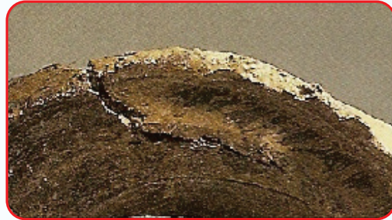
شكل ( ٥٢ ) : يوضح نتائج أخطاء التجفيف ( تشقق ).
