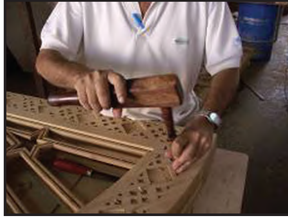
(١): استخدام المدق الخشبي، وهي الأداة الصحيحة.
