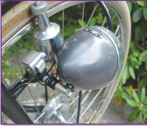
يتصل المولد الكهربائي بعجلة الدراجة
