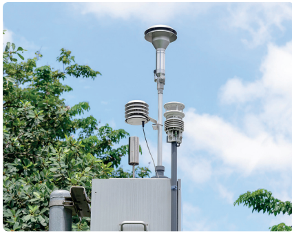
شكل 3.5: محطة جودة هواء ذكية
