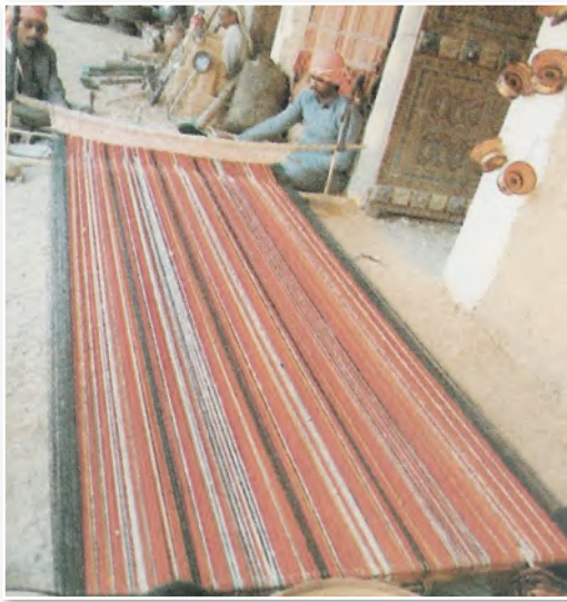
الشكل (٩): نول أرضي لإنتاج قطعة كبيرة.
