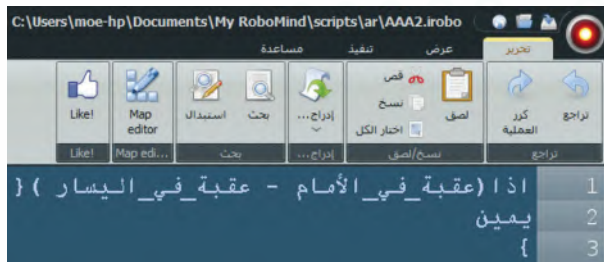
شكل (٢-٦-٥): أمر برمجي لشرط ينفذ فيه يقوم الروبوت مهمة إذا تحقق أحد أوامر المشاهدة.
